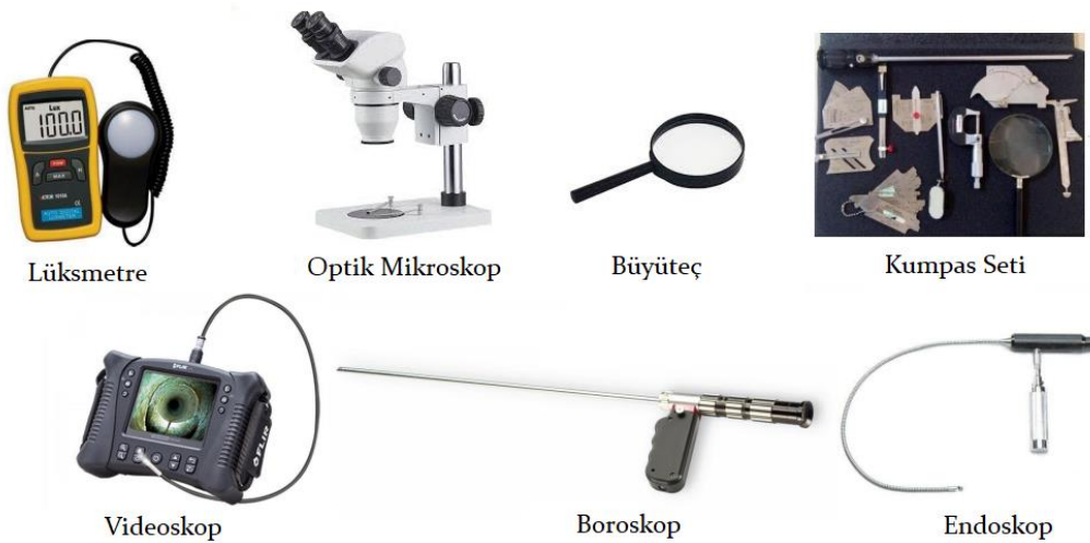
Şekil 1.1. Görsel muayenede kullanılan bazı yardımcı araçlar (Url: 1)
